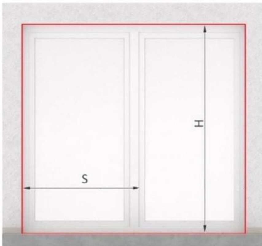
Rys. 2. Sposób pomiaru moskitiery na oknie przesuwным dwuskrzydłowym
